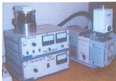
รูป 3.21 เครื่อง Sputter coater รุ่น SC7620
