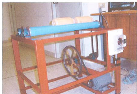
รูป 3.2 แท่นหมุนพร้อมมอเตอร์สำหรับหมุนกระป๋องเพื่อบดย่อยผสมสารแบบ Ball milling
