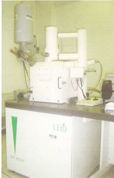
รูป 3.22 กล้องจุลทรรศน์อิเล็กตรอนแบบส่องกราด บริษัท LEO รุ่น 1455VP
