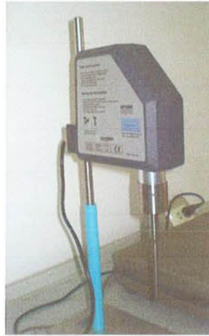
รูป 3.7 เครื่อง Ultrasonic Processor ที่ใช้ในการกระจายอนุภาคของสารเจือ \text{MgO} และ \text{ZrO}_2
