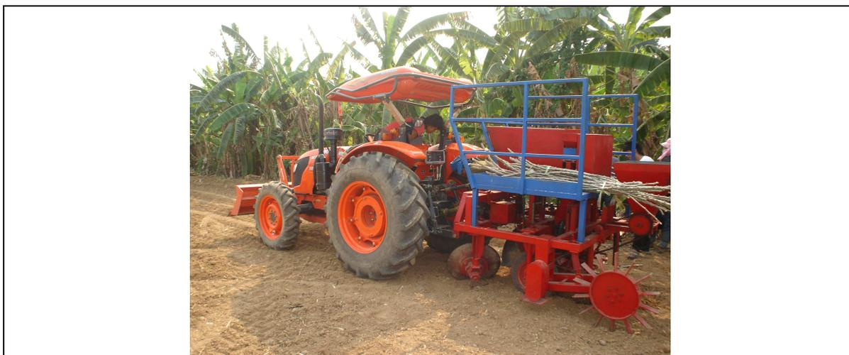
รูปที่ 4.4 เครื่องปลูกมันสำปะหลังต้นแบบ
