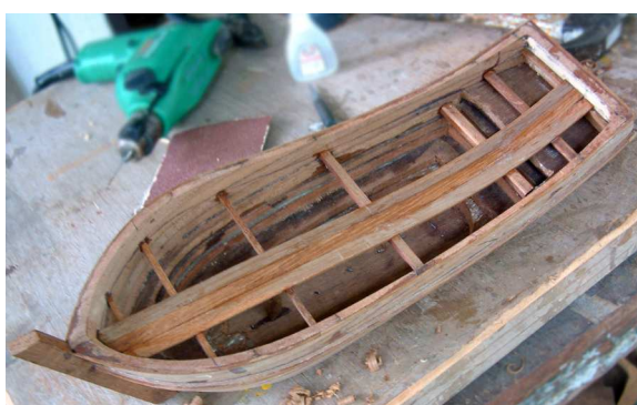
ภาพที่ 26 การปูพื้นเรือที่เป็นการต่อเรือแบบซ้อนไม้
