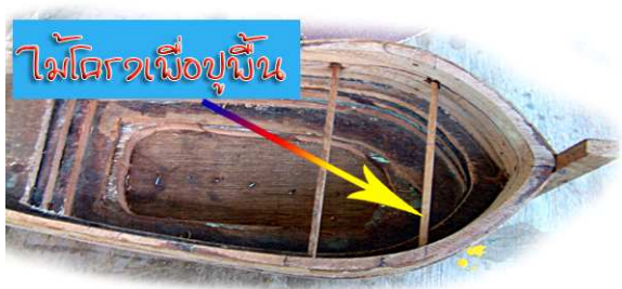
ภาพที่ 25 โครงสร้างไม้ปูพื้นเรือแบบซ้อนไม้
