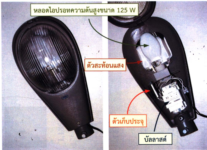
รูปที่ 4-1 โคมไฟถนนหลังเต่าพร้อมชุดส่องสว่างของหลอดไอปรอทความดันสูง ขนาดกำลัง 125 W ค่าฟลักซ์ส่องสว่างอยู่ที่ 6,800 lm
