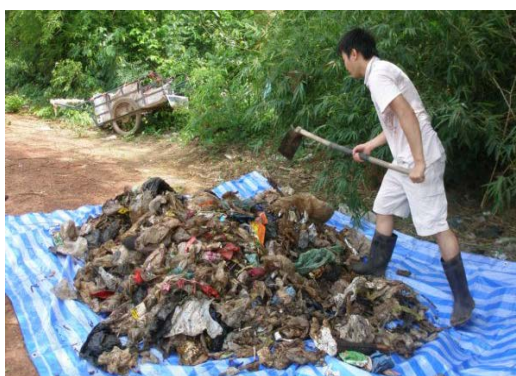
รูปที่ 3.1-4 การคลุกเคล้าตัวอย่างขยะมูลฝอยให้ผสมกันอย่างทั่วถึง
