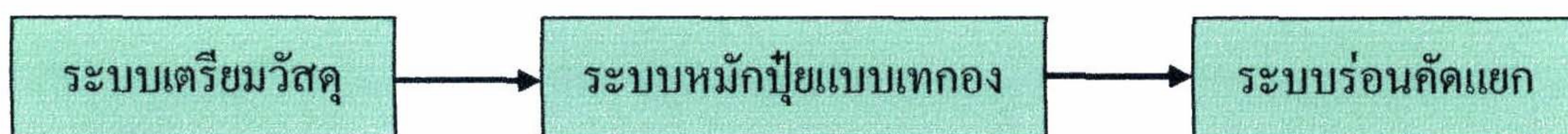
รูปที่ 4.4-2 ขั้นตอนและองค์ประกอบของเทคโนโลยีการหมักปุ๋ยแบบกองแถวพลิกกลับเอง
