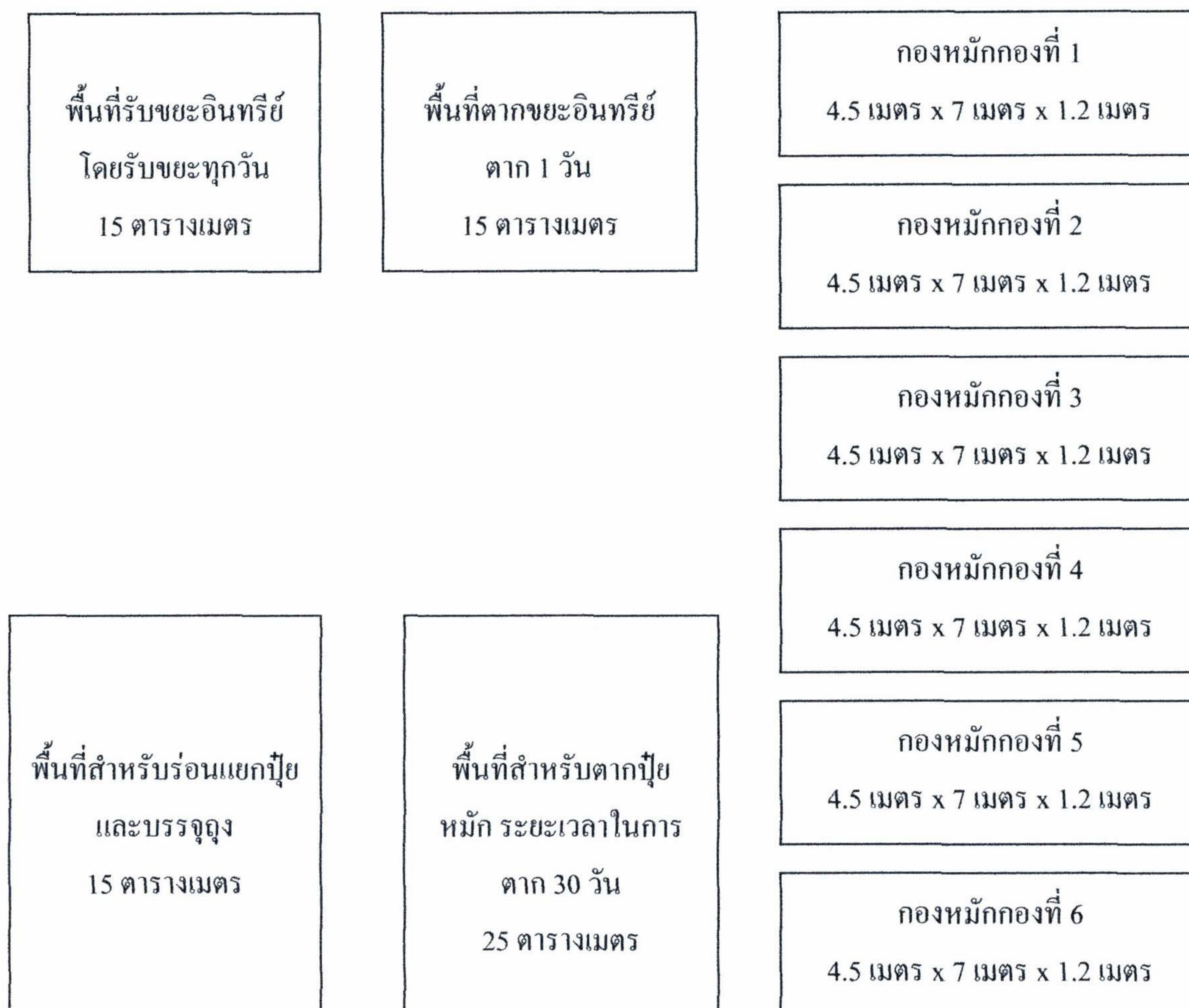
รูปที่ 4.4-3 แผนผังของระบบผลิตปุ๋ยหมัก
