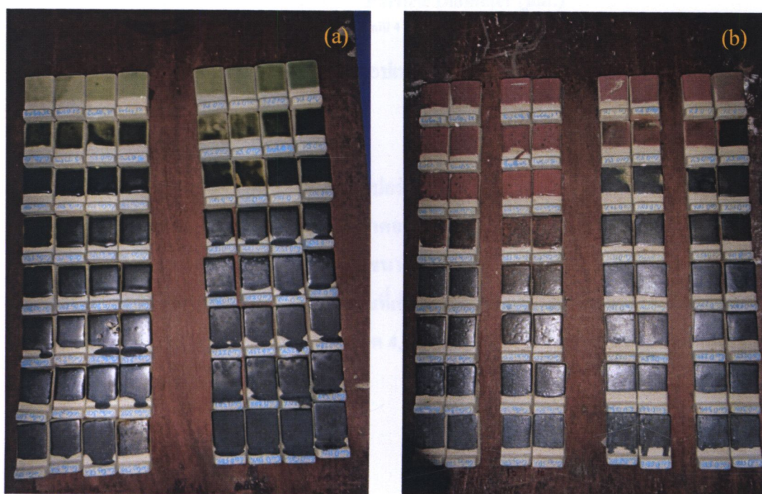
รูป 4.1 การทดสอบเคลือบเบื้องต้นที่ปริมาณต่างๆ (a) คือการเผาในบรรยากาศออกซิเดชัน (b) คือการเผาในบรรยากาศรีดักชัน
