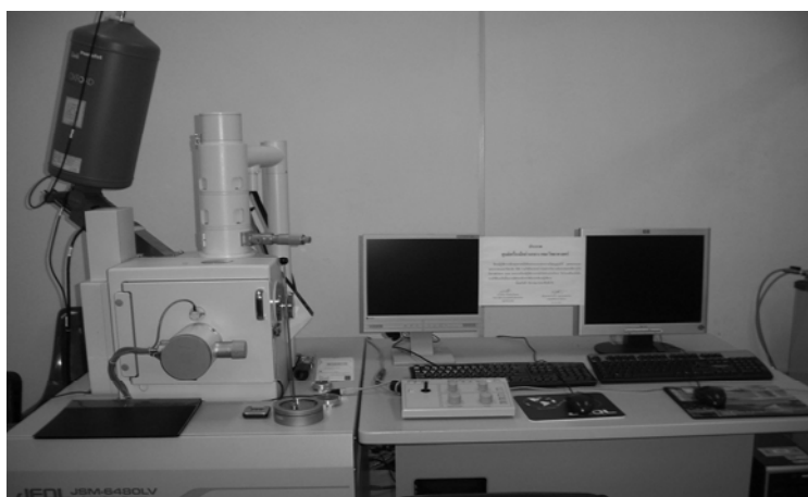
ภาพที่ 24 กล้องจุลทรรศน์อิเล็กตรอนแบบส่องกราด
