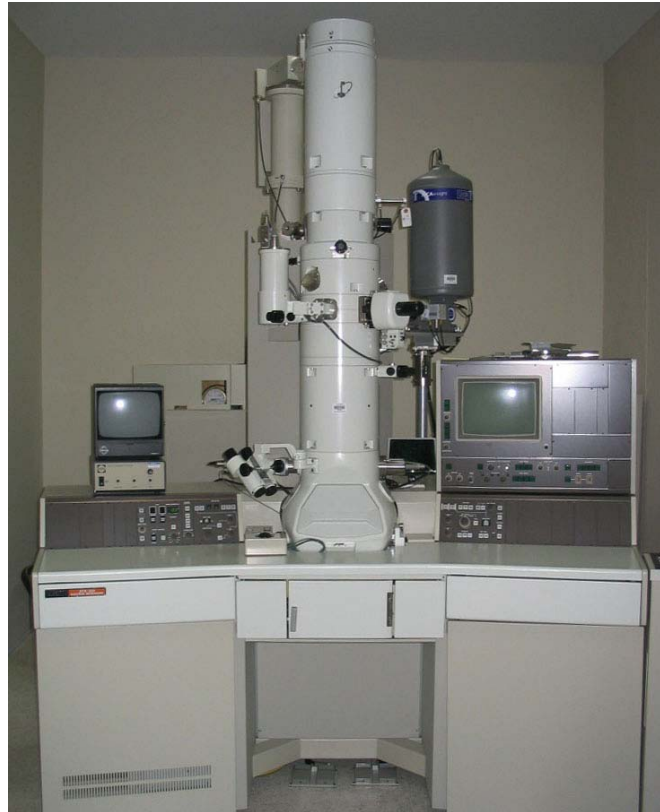
รูป ก.4. กล้องจุลทรรศน์อิเล็กตรอนแบบส่องผ่าน รุ่น JSM-2010 ผลิตโดยบริษัท JEOL ประเทศ ญี่ปุ่น
