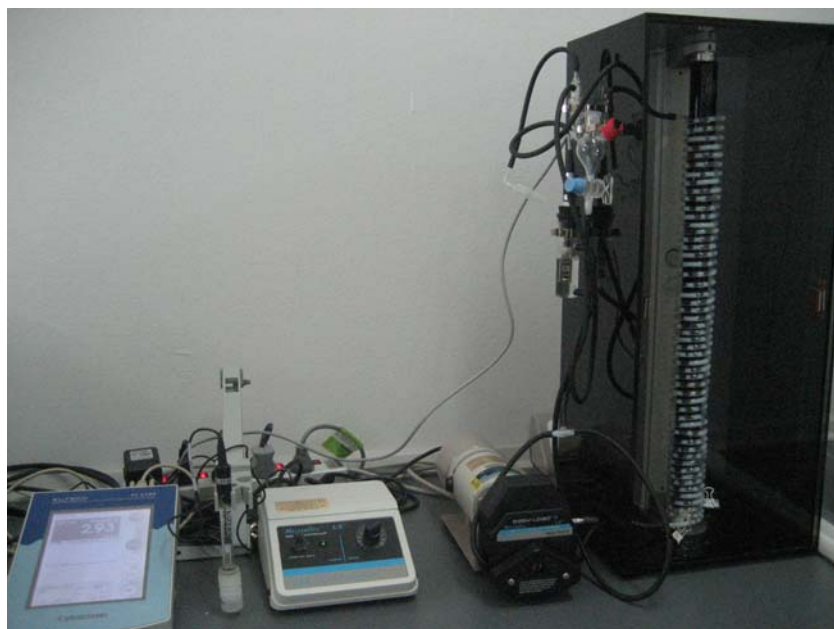
รูป ก.4. ชุดเครื่องมือวัดความสามารถโฟโตแคทาลิติก ประกอบด้วย เครื่อง spiral reactor ที่ประกอบขึ้นเอง, เครื่องปั้มน้ำผลิตโดยบริษัท Extech equipment และเครื่องวัดค่านำไฟฟ้า รุ่น Cyberscan PC 5500/5000 ผลิตโดยบริษัท Eutech Instrument
