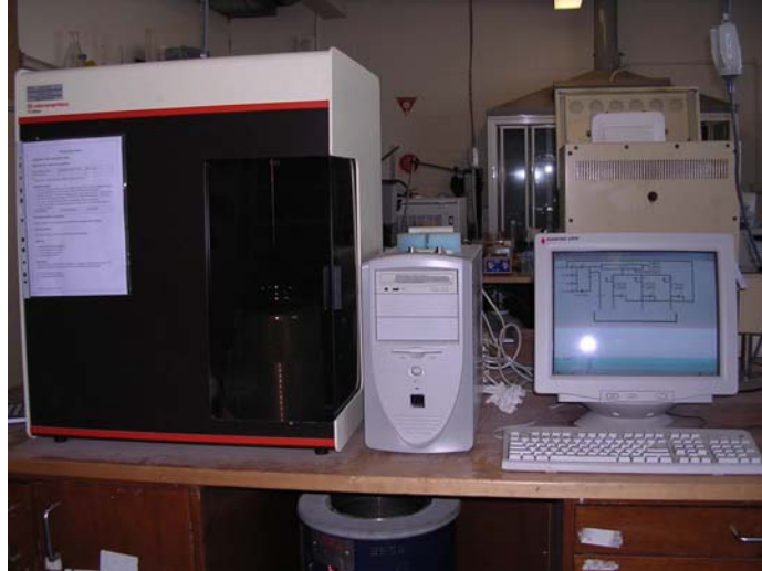
รูป ก.3. เครื่องวัดพื้นที่ผิวของอนุภาค รุ่น Micromeritics TriStar 3000 V5.02
