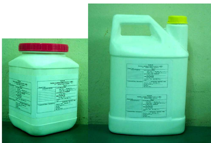
ภาพที่ 17 ภาชนะบรรจุของเสียเคมีวัตถุ/กากสารเคมีของเหลวขนาด 1 ลิตร และ 4 ลิตร
