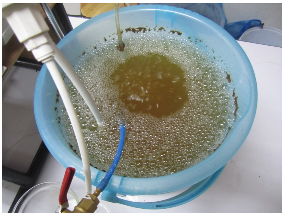
ภาพที่ ง.4 ถังเติมอากาศ
