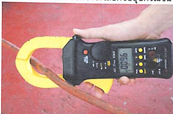
รูปที่ 4.2 การวัดค่ากระแสด้านหตุยภูมิด้วยแคลลมมิเตอร์
