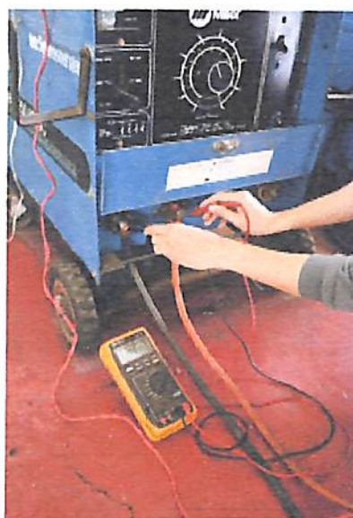
รูปที่ 4.3 การวัดค่าแรงดันด้านหตุยภูมิด้วยมัลติมิเตอร์
