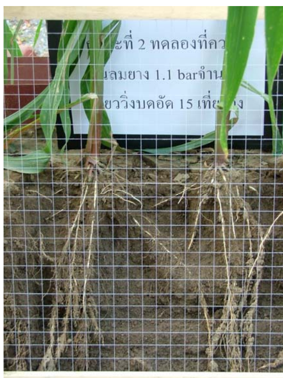
ภาพที่ 112 แสดงลักษณะการแพร่กระจายของรากข้าวโพดในกระบะดินที่ได้รับการบดอัด จำนวน 15 เทียววึ่ง ที่ความดันลมยาง 1.1 bar (1.12 kgf/cm 2 )
