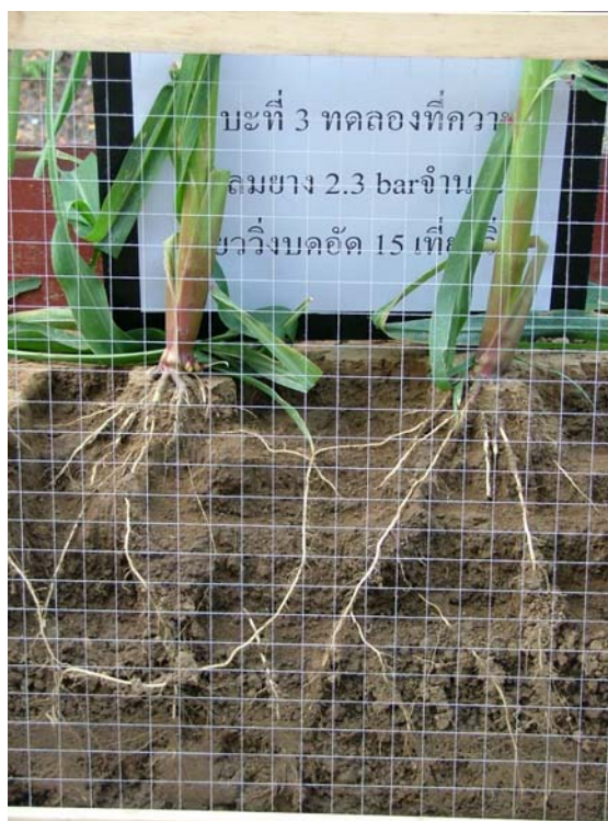
ภาพที่ 113 แสดงลักษณะการแพร่กระจายของรากข้าวโพดในกระบะดินที่ได้รับการบดอัด จำนวน 15 เทียววึ่งที่ความดันลมยาง 2.3 bar ( 2.34 \text{ kgf/cm}^2 )
