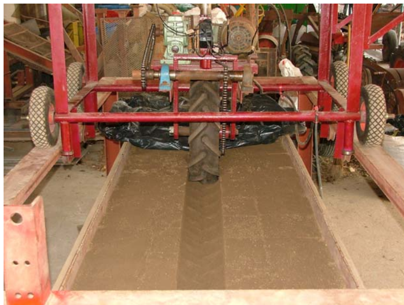
ภาพที่ 35 แสดงสภาพดินหลังจากที่ล้อยางวิ่งบดอัดบนผิวหน้าดิน
