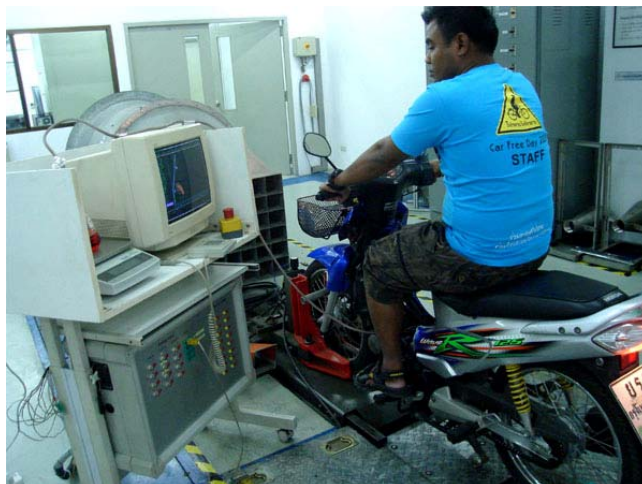
ภาพที่ 27 การทดสอบการขับจักรยานยนต์บนแชสซิสไดนาโมมิเตอร์
