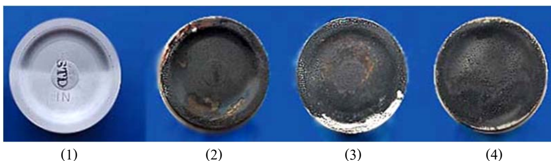
ภาพที่ 42 ผิวหน้าของลูกสูบภายหลังจากการทดสอบในรถจักรยานยนต์ระบบคาร์บูเรเตอร์เมื่อใช้เชื้อเพลิงทดสอบชนิดต่างๆ (1) ลูกสูบไม่ผ่านการใช้งาน (2) น้ำมันเบนซิน 91 (3) เชื้อเพลิงผสมน้ำมันเบนซิน-สบูดำร้อยละ 5 (4) เชื้อเพลิงผสมน้ำมันเบนซิน-สบูดำร้อยละ 10
