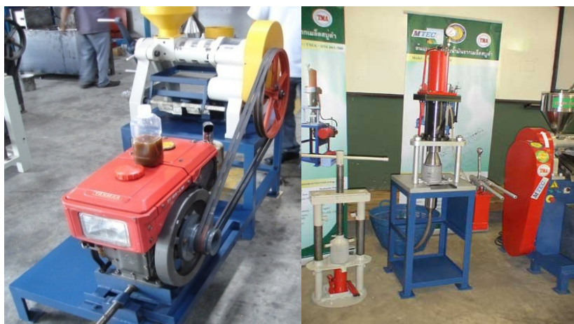
ภาพที่ 9 เครื่องหีบน้ำมันสบู่ดำแบบอัดเกลียว (ซ้าย) และแบบระบบไฮดรอลิก (ขวา)
