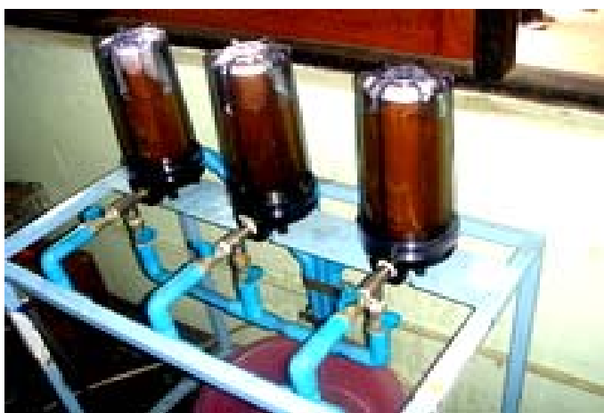
ภาพที่ 11 เครื่องกรองขนาด 3 ไมครอนสำหรับกรองตะกอนปนเปื้อนจากน้ำมันสบู่อ้อย
