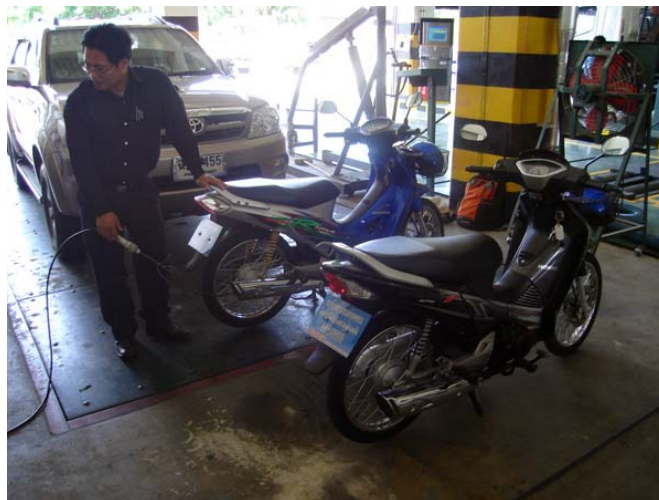
ภาพที่ 25 การตรวจวัดสารมลพิษขณะเดินเบา ณ สำนักวิศวกรรมและความปลอดภัย กรมการขนส่งทางบก
