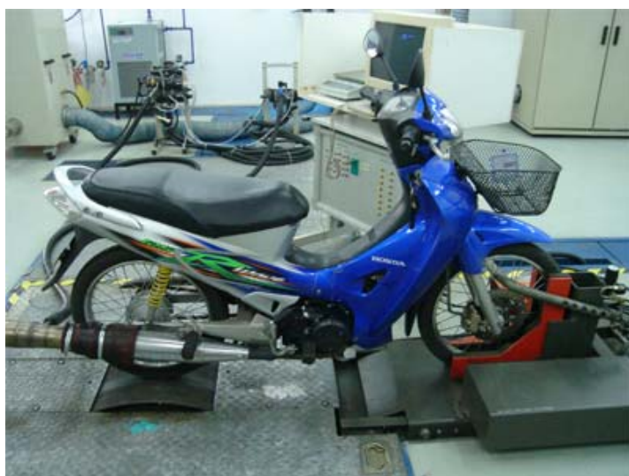
ภาพผนวกที่ ข5 การเตรียมรถจักรยานยนต์บนแท่นทดสอบไดนาโมมิเตอร์
