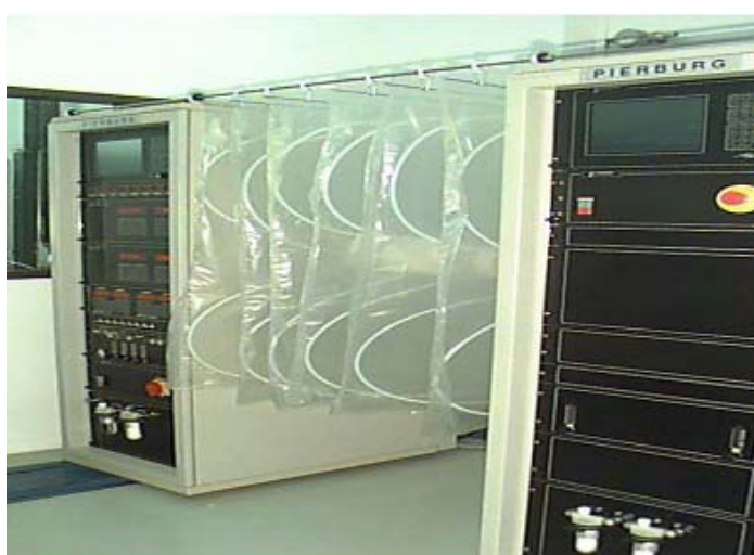
ภาพที่ 17 อุปกรณ์วิเคราะห์สารมลพิษในไอเสียและดูดเก็บตัวอย่างไอเสีย
