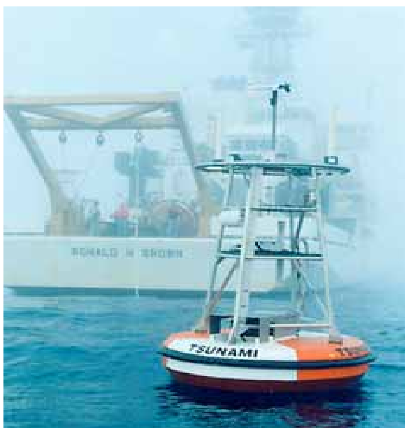
ภาพที่ 7 ทุ่นวัดแรงสั่นสะเทือนจากแผ่นดินไหว
