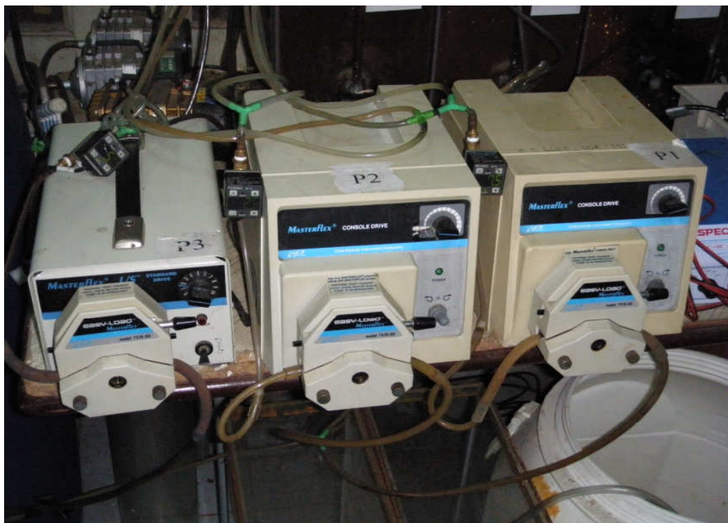
ภาพผนวกที่ ค2 ป้อนสุบน้ำผ่านเมมเบรน
