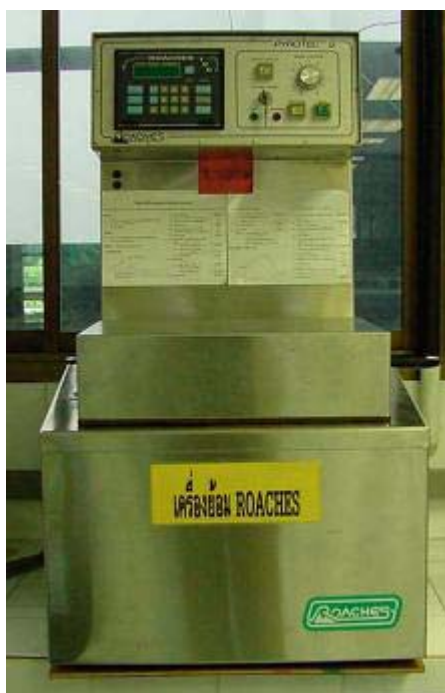
ภาพผนวกที่ 2ก Roaches Beaker Dyer (single bath PYROTECS , Model T.P.C. 1001)
