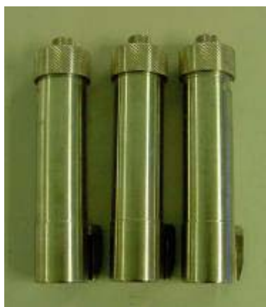
ภาพผนวกที่ 2ข กระบอกเหล็ก ขนาด 200 มิลลิลิตร ที่ใช้ในการย้อม
