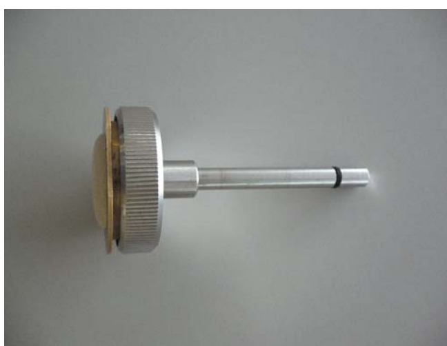
ภาพผนวกที่ 4ข abrasion holder สำหรับการทดสอบความคงทนต่อการขัดถู
