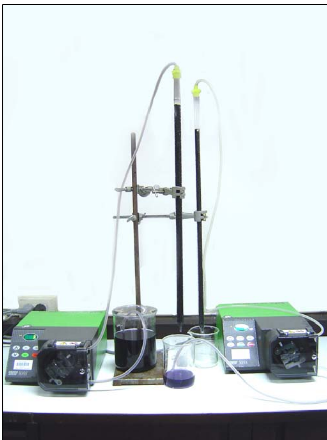
ภาพที่ 20 ระบบบำบัดน้ำเสียที่ทำการศึกษา โดยการดูดซับด้วยถ่านกัมมันต์
