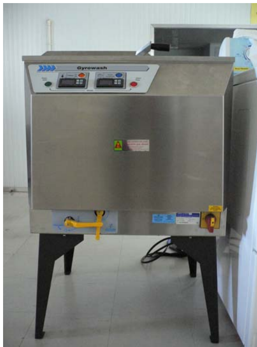
ภาพผนวกที่ 3ก เครื่องทดสอบความคงทนของสีต่อการซัก
