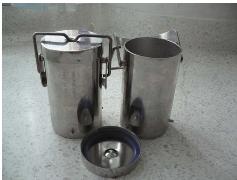
ภาพผนวกที่ 3ข กระบอกซักที่ใช้ในการทดสอบความคงทนของสีต่อการซัก
