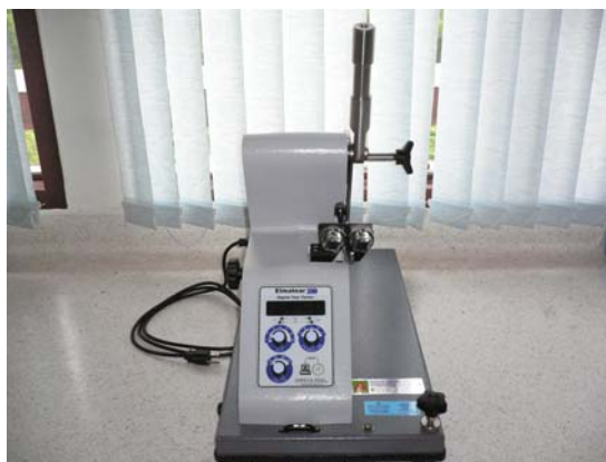
ภาพผนวกที่ 5ก เครื่องทดสอบความคงทนต่อแรงฉีกขาด ทดสอบได้ด้วย Elmendorf Tearing Tester
