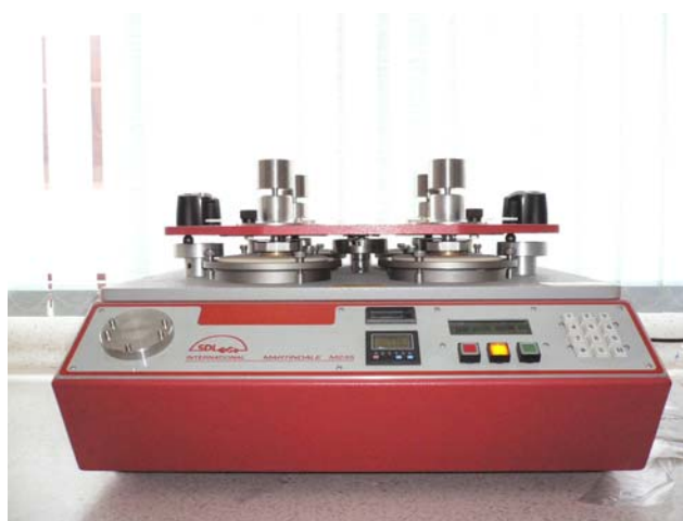
ภาพผนวกที่ 4ก เครื่องทดสอบความคงทนต่อการขัดถู Martindale M235
