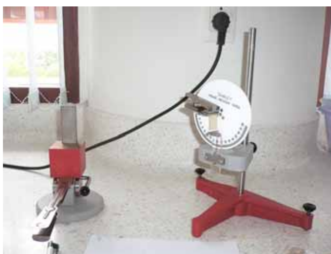
ภาพผนวกที่ 6 เครื่องทดสอบการคืนตัวจากการยับ Shirley Crease Recovery Tester
