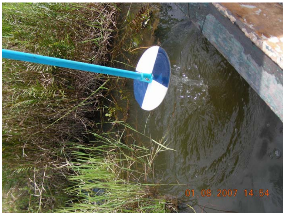
ภาพผนวกที่ ข1 เครื่องมือวัดความโปร่งแสง (Secchi disc)
