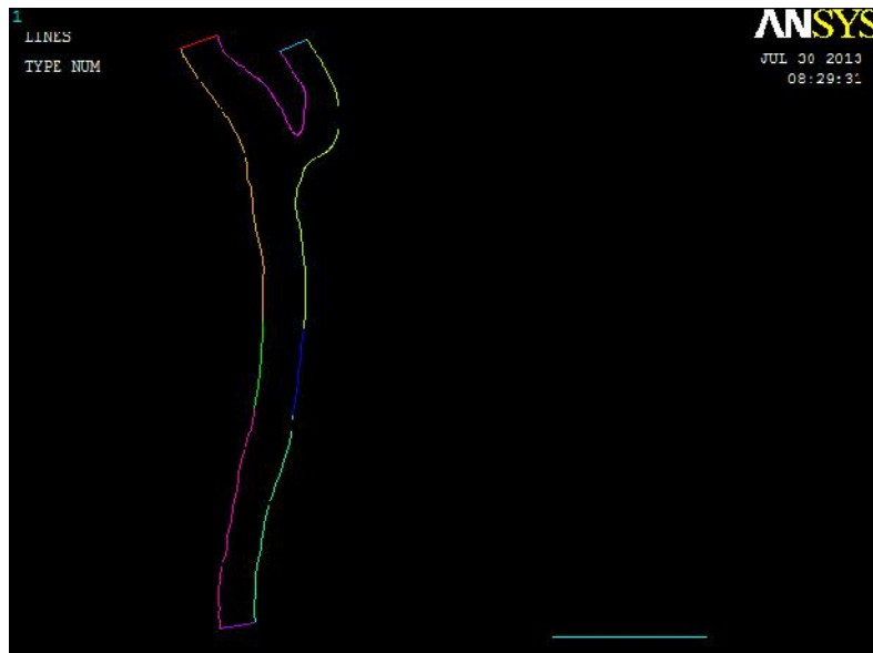
รูปที่ 4 ภาพโครงร่าง 2 มิติของหลอดเลือดเมื่อนำเข้าสู่โปรแกรมคอมพิวเตอร์ ANSYS
