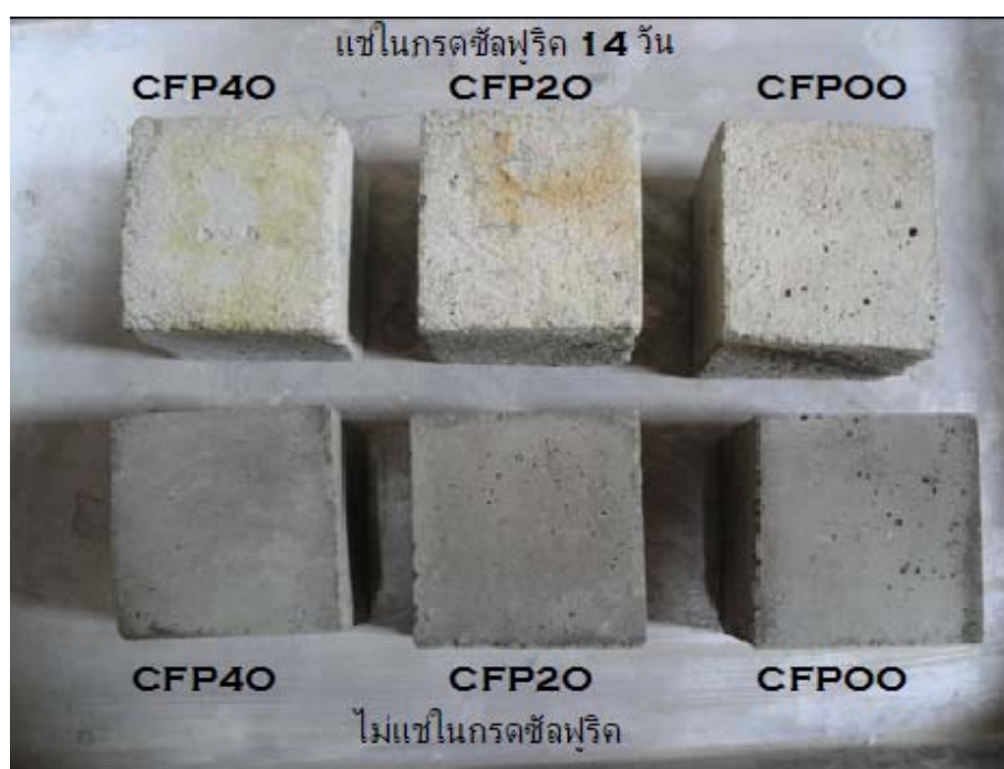
ภาพที่ 4.16 การกัดกร่อนจากกรดซัลฟูริกของมอร์ตาร์
