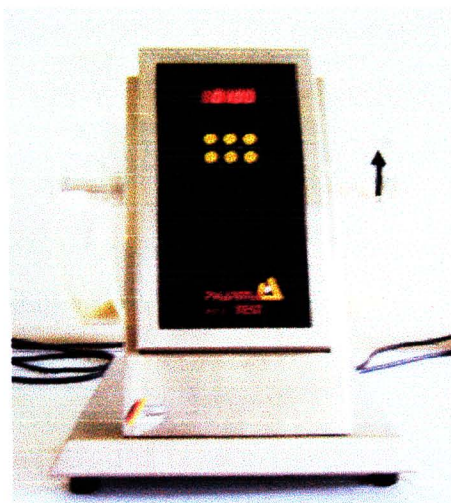
รูปที่ 2-9 แสดงการทดสอบความกร่อนของแกรนูลโดยเครื่อง Friability tester
