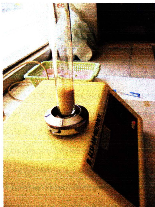
รูปที่ 2-10 แสดงการหาค่า compressibility โดย Jolting Volumeter
