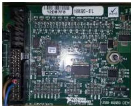
ภาพที่ 3.11 วงจรวัดแรงดันไฟฟ้า
