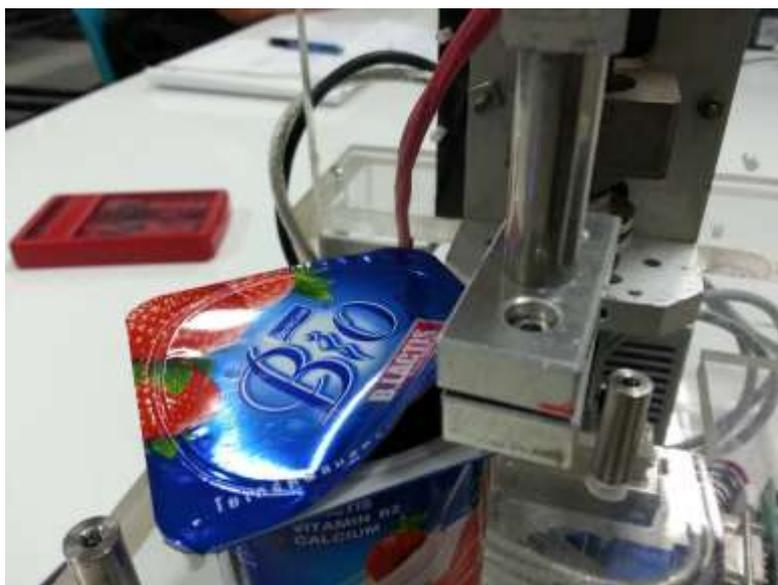
ภาพที่ 3.30 การทดสอบแบบดึง
