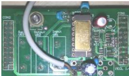
ภาพที่ 3.3 วงจรขยายสัญญาณแบบเครื่องมือวัดโดยใช้ IC เบอร์ AD624
