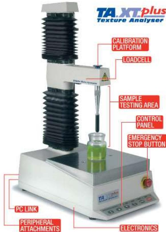
ภาพที่ 2.2 เครื่อง Texture Analyser รุ่น TA.XT plus
