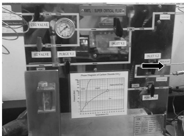
รูปที่ 3.5 การเปิดวาล์วที่แผงควบคุมความดันเพื่ออัดแก๊สคาร์บอนไดออกไซด์ไปยังภาชนะทนความดันสูง
