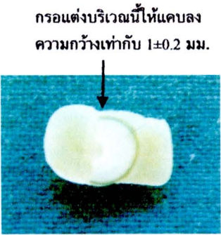
ภาพ 16 แสดงแผ่นชั้นตัวอย่างที่ตัดด้วยเครื่องตัดชั้นตัวอย่าง
