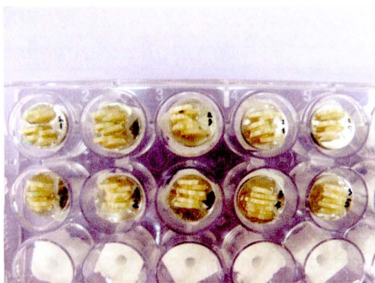
ภาพ 20 แสดงการติดชิ้นตัวอย่างบนแท่นสำหรับติดชิ้นตัวอย่าง
