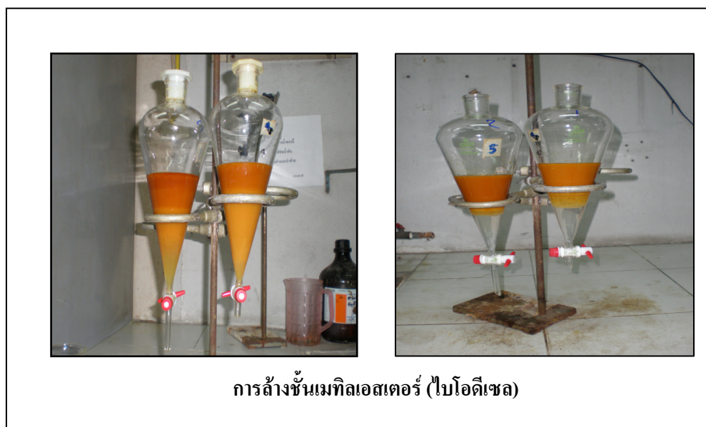
ภาพผนวกที่ จ4 ขั้นตอนการล้างชั้นเมทิลเอสเทอร์(ชั้นไบโอดีเซล) ก่อนนำไปใช้ความชื้น
