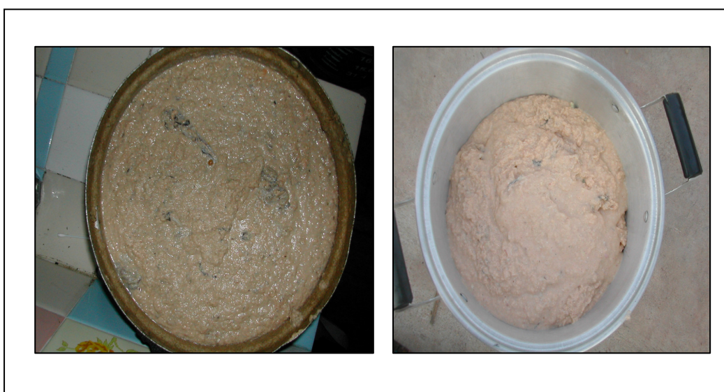
ภาพผนวกที่ จ2 ตัวอย่างชั้นตะกอนไขมันปลาทะเลก่อนการสกัดแยกชั้นน้ำมันด้วยวิธีการเจียวด้วยความร้อน
