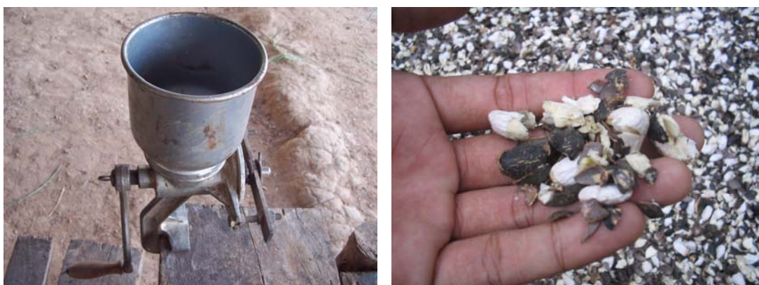
ภาพที่ 9 เครื่องบดเมล็ดสบูดำ และเมล็ดสบูดำหลังจากการบด
