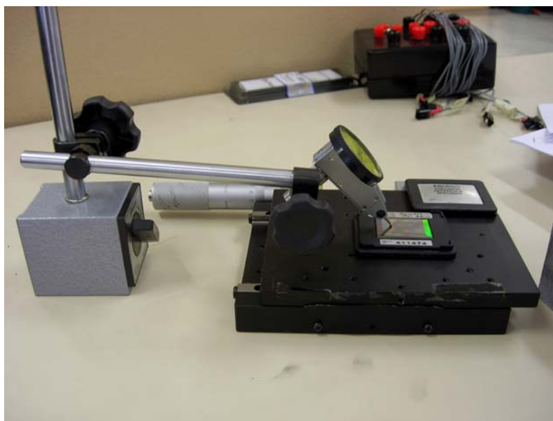
ภาพที่ 40 ชุดอุปกรณ์วัดค่าความหยาบละเอียดผิว
