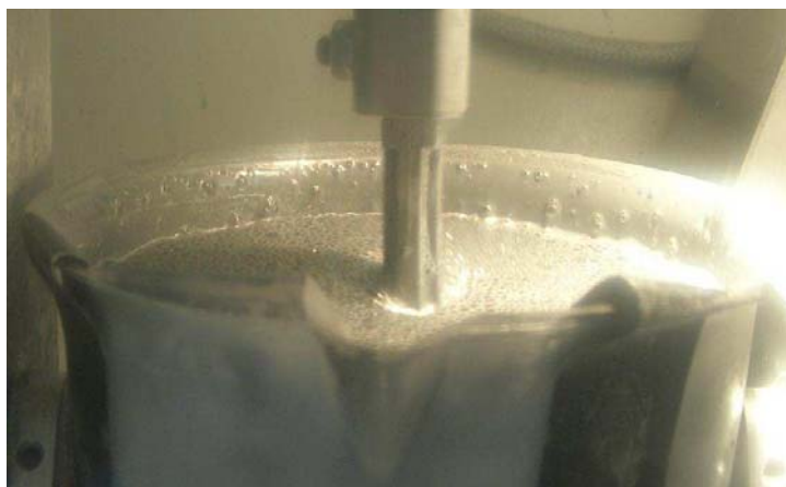
ภาพที่ 44 เกิดฟองอากาศในกระบวนการกวนส่วนผสมให้เข้ากัน และดึงอากาศออกจากส่วนผสม
