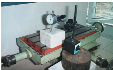
ภาพที่ 30 พื้นผิวที่ได้จากการวัดโดยใช้ dial gauge
