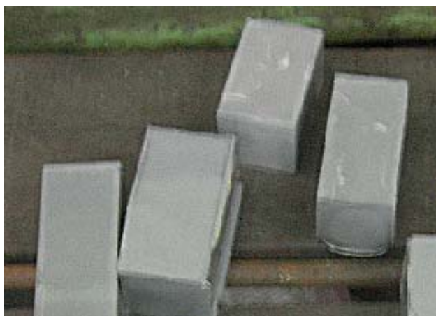
ภาพที่ 46 ชิ้นงานอิพอกซีเรซินเติมอะลูมิเนียมที่ผ่านการหล่อ
