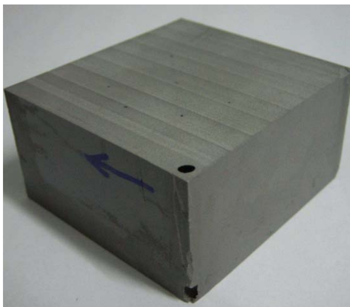
ภาพที่ 47 การเกิดโพรงอากาศที่บริเวณขอบชิ้นงาน
