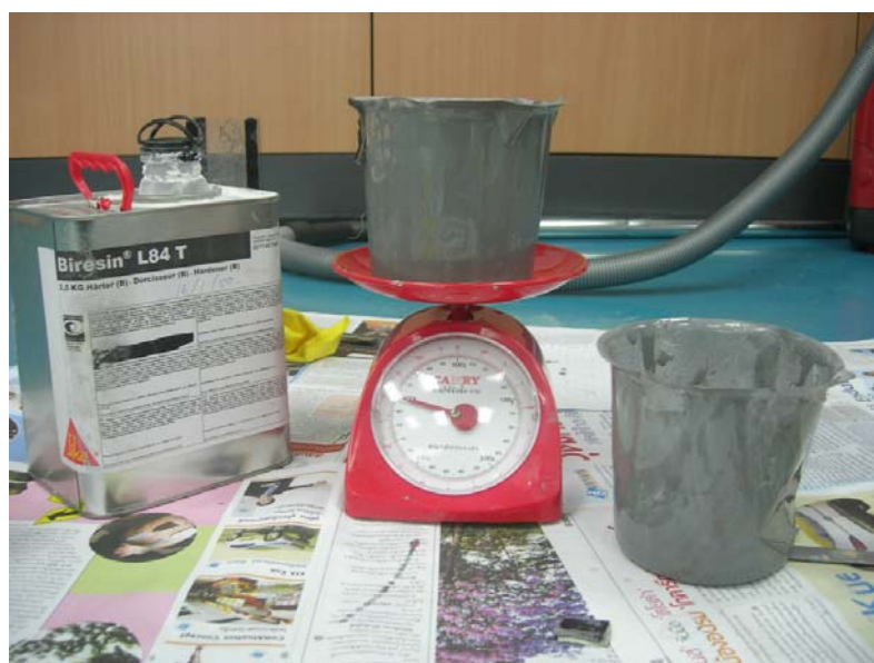
ภาพที่ 43 การเตรียมส่วนผสมในการหล่อชิ้นงานอีพอกซีเรซินเติมอะลูมิเนียม
