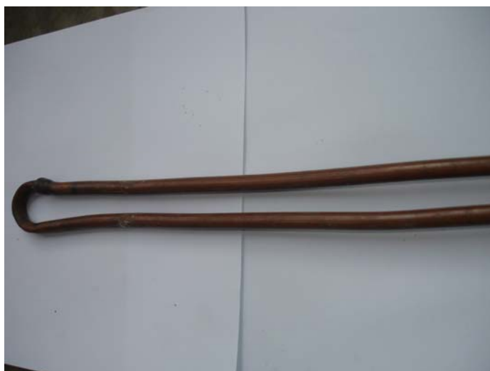
ภาพที่ 7 ท่อทองแดงใช้เป็นท่อนำความร้อนในระบบ
