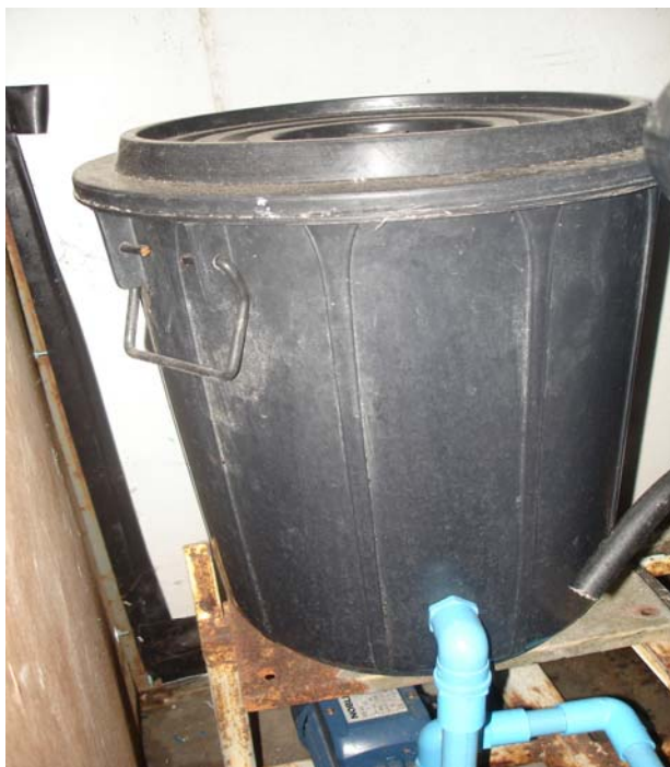
ภาพที่ 8 ถังเก็บน้ำก่อนเข้าแผงรับแสง
