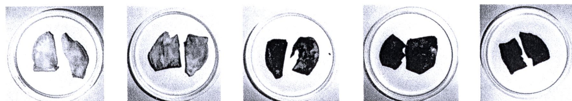
รูปที่ 17 ลักษณะที่ปรากฏของชิ้นทุเรียนทอดที่อุณหภูมิน้ำมัน 190 °C เป็นเวลา 2, 4, 6, 8, 10 นาที เมื่อ รูปบน เป็นตัวอย่างที่ไม่ได้เคลือบฟิล์ม และ รูปล่าง เป็นตัวอย่างที่เคลือบด้วยฟิล์มแป้งเม็ดทุเรียนก่อนนำไปทอดน้ำมัน
