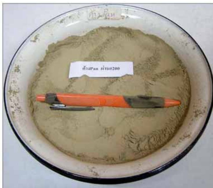
ภาพผนวกที่ 16 จีตะกอน เมื่อนำมาบดแล้วร่อนค้ำบนตากรองรับ
