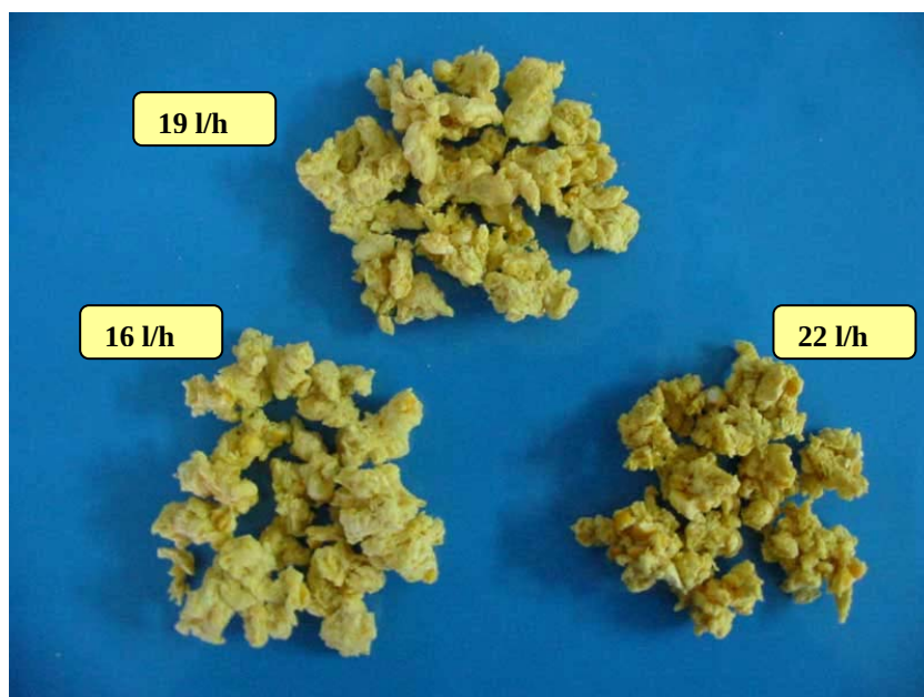
ภาพผนวกที่ ค1 ข้าวโพดทั้งเมล็ดที่ผ่านกระบวนการเอกซ்தรูล์ชั้น ณ อัตราการไหลของน้ำเข้าเครื่อง ที่ 16, 19 และ 22 ลิตร/ชั่วโมง
