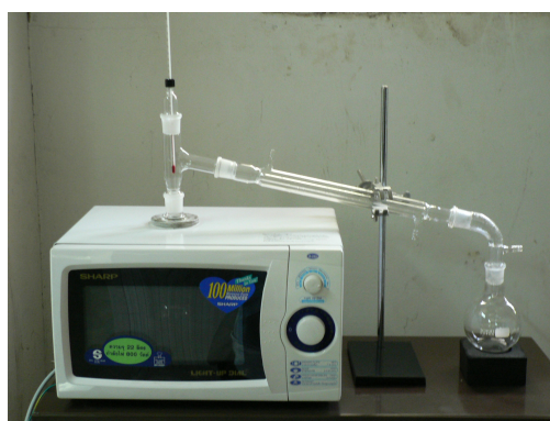
ภาพที่ 32 เครื่องกลั่นน้ำมันหอมระเหยโดยใช้วิธีไมโครเวฟที่สร้างขึ้น
