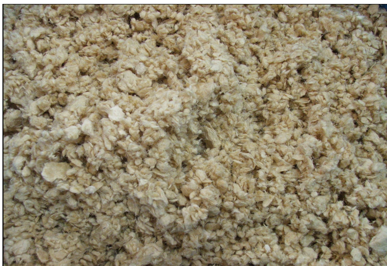
ภาพที่ 12 ลักษณะเส้นใยหลังจากบดเส้นใยด้วยเครื่อง Refiner ของไม้ตินเป็ดอายุ 9 ปี ที่ปฏิบัติ เบื้องต้นกับจีนไม้สับด้วยโซเดียมไฮดรอกไซด์ 20%
