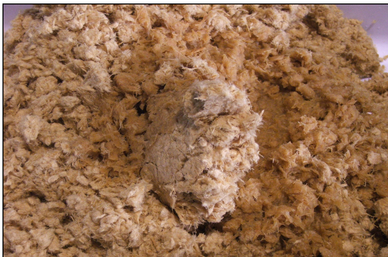
ภาพที่ 11 ลักษณะเส้นใยหลังจากแยกเส้นใยด้วยเครื่อง Defibrator ของไม้ตินเป็ดอายุ 9 ปี ที่ปฏิบัติ เบื้องต้นกับจีนไม้สับด้วยโซเดียมไฮดรอกไซด์ 20%
