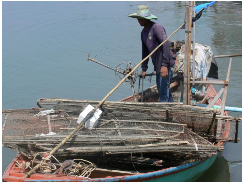
ภาพที่ ๒๔ เครื่องมือลอบหมึกแบบพับได้ บริเวณอ่าวไทยฝั่งตะวันออก
