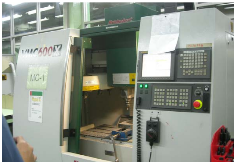
ภาพที่ 57 เครื่องกัดซีเอ็นซีที่ใช้กัดผิวชิ้นงาน
