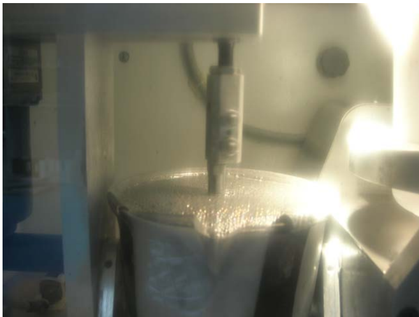
ภาพที่ 52 เกิดฟองอากาศในกระบวนการกวนส่วนผสมให้เข้ากัน และดึงอากาศออกจากส่วนผสม
