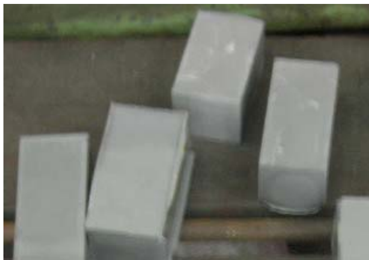
ภาพที่ 50 ชิ้นงานอีพอกซีเรซินเติมอะลูมิเนียมที่ผ่านการหล่อ
