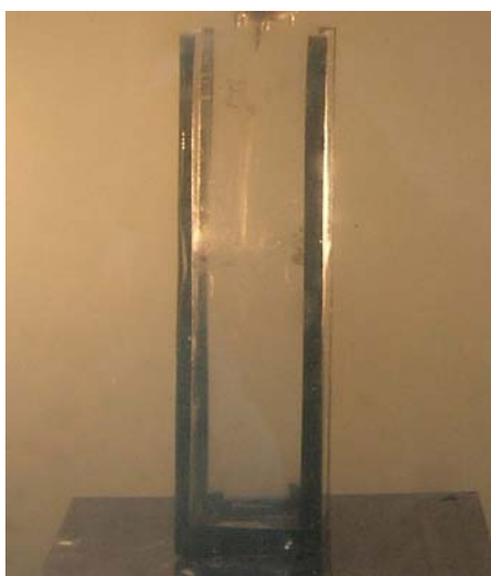
ภาพที่ 48 แม่แบบหล่อชิ้นงาน
