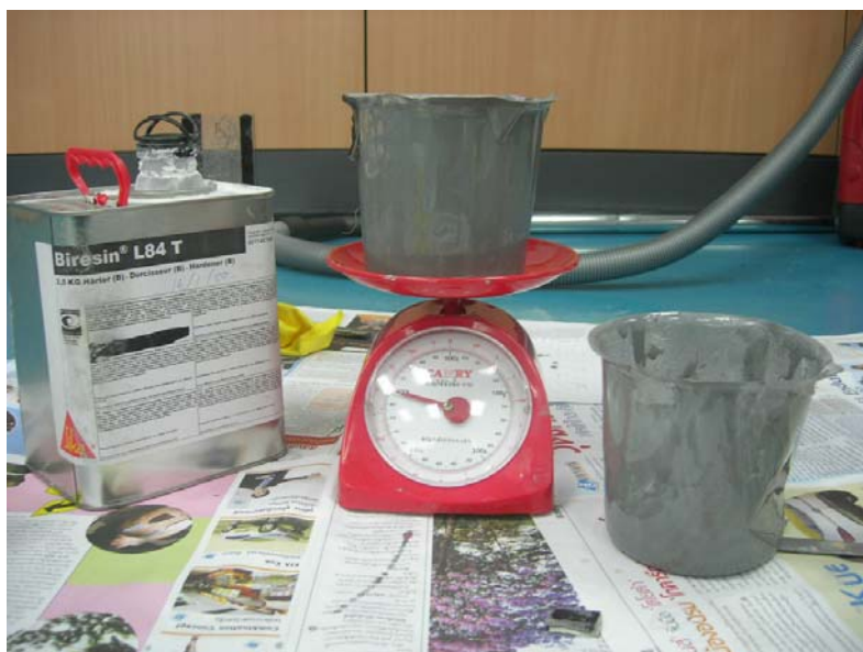
ภาพที่ 49 การเตรียมส่วนผสมในการหล่อชิ้นงานอิพอกซีเรซินเติมอะลูมิเนียม
