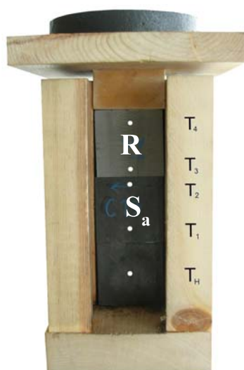
ภาพที่ 46 แสดงตำแหน่งที่วัดอุณหภูมิ
