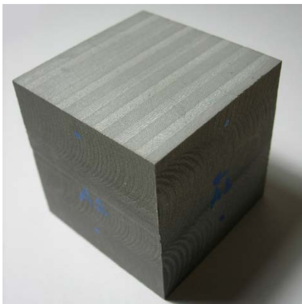
ภาพที่ 55 ชิ้นงานอีพอกซีเรซินเติมอะลูมิเนียมที่ผ่านการกัด
