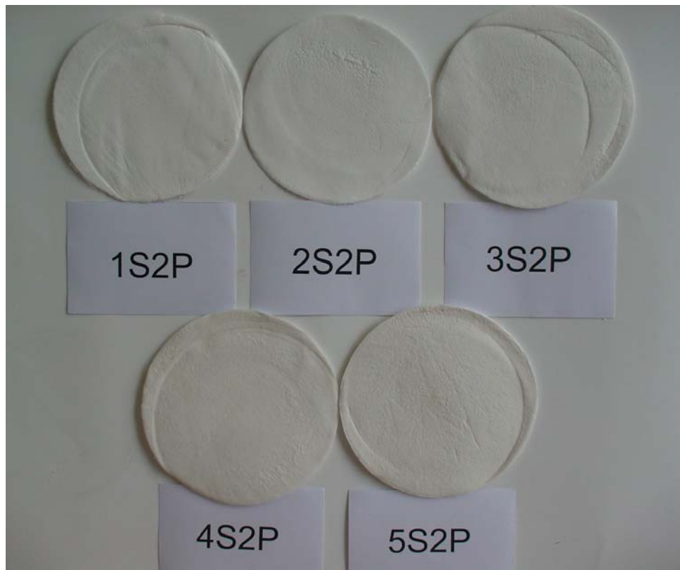
ภาพที่ 12: ลักษณะทางกายภาพของแผ่นเนื้อเยื่อที่มีส่วนประกอบของ polyvinyl alcohol ร้อยละ 2 และมีโปรตีน กาวไหมเป็นส่วนประกอบอยู่ตั้งแต่ร้อยละ 1-5 ตามลำดับ
