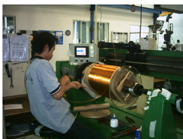
ภาพที่ 1 แสดงหน่วยผลิต High Volt ของหม้อแปลงไฟฟ้าแรงสูง
