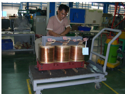
ภาพที่ 4 ภาพแสดงหน่วยผลิต Assembly ของหม้อแปลงไฟฟ้าแรงสูง
