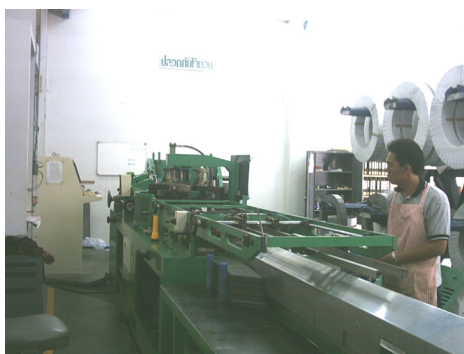
ภาพที่ 2 แสดงหน่วยผลิต Cut ของหม้อแปลงไฟฟ้าแรงสูง
