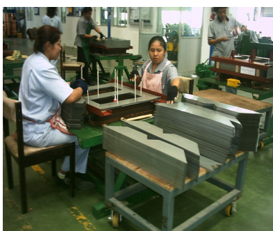
ภาพที่ 3 แสดงหน่วยผลิต Stacking ของหม้อแปลงไฟฟ้าแรงสูง
