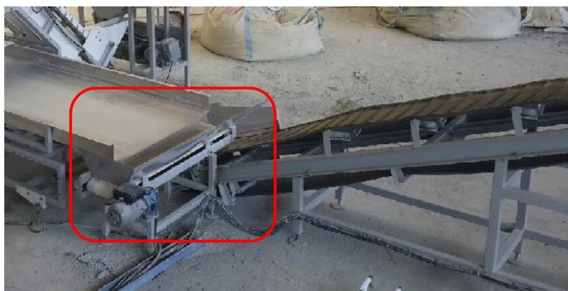
ภาพที่ 3.8 สายพานลำเลียงวัตถุดิบจากถาดเหวี่ยงเครื่องผสมและขึ้นรูปผงแร่ทัลค์อัดเม็ด
