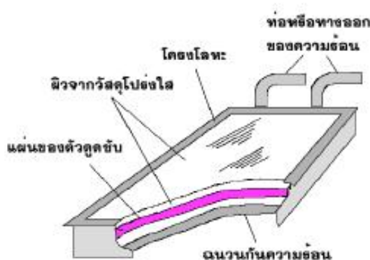
ภาพที่ 2.12 ส่วนประกอบของตัวกักเก็บความร้อนจากรังสีแสงอาทิตย์
