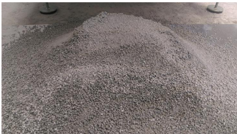
ภาพที่ 3.7 ลักษณะการปั่นคลึงผงแร่ทลคมให้เป็นรูปเม็ดกลม
