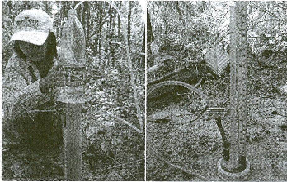
ภาพ 3-15 การวัดสภาพให้น้ำซึมผ่าน (Infiltration rate)
