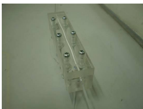
รูปที่ 12 อุปกรณ์การแยกด้วยเมมเบรนชนิดเส้นใยกลวงและสัญญาณ Background
