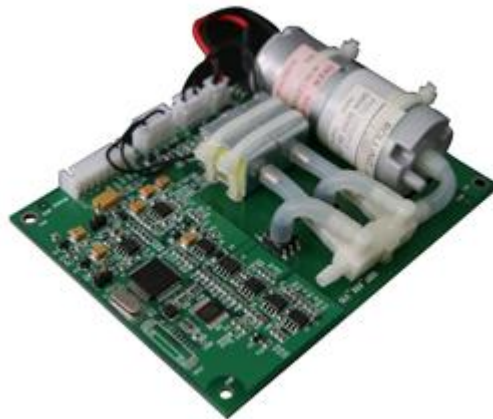
ภาพที่ 5 B) ภาพแสดงหน่วยวัดความดันโลหิต (Non-Invasive Blood Pressure module) ที่รวมระบบอัดความดัน ตัววัดความดัน และ microcontroller เข้าไว้ด้วยกัน
