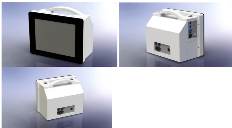
ภาพที่ 22 ภาพแสดงตัวถังอุปกรณ์เคลื่อนที่ จากโดยจะมีหุ้มหีและระบบจ่ายไฟฟ้าในตัว
