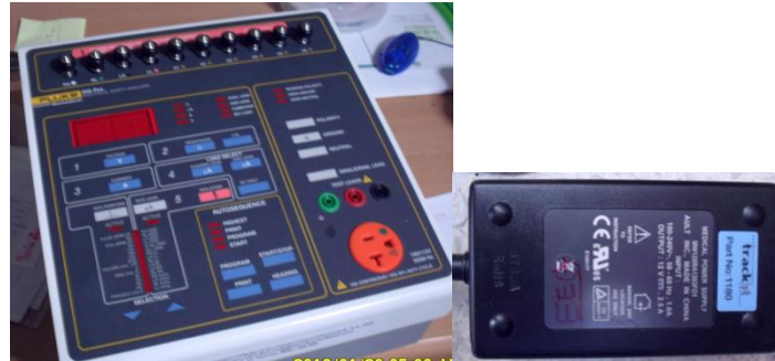
ภาพที่ 14 A) ภาพบน Fluke-Bio-Tek 505 Pro Electrical Safety Analyser ภาพล่างแสดง medical grade power supply AULT MW128R ที่ใช้ในการทดสอบ
