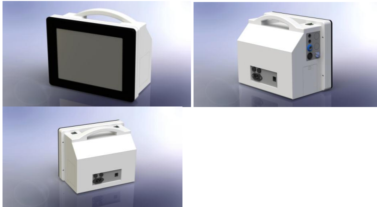
ภาพที่ 15 ภาพแสดงตัวถังอุปกรณ์เคลื่อนที่ จากโดยจะมีหุ้มและระบบจ่ายไฟฟ้าในตัว
