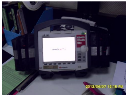
ภาพที่ 14 เครื่องเฝ้าระวังสัญญาณชีพ รุ่น Corpus สามารถส่งสัญญาณ สูงไม่เกิน 100 m จากพื้นดิน ผ่านระบบ internet
