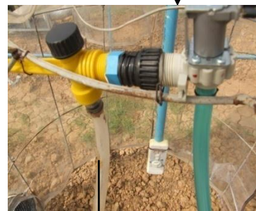
เครื่องบันทึกอุณหภูมิด้วยระบบอิเล็กทรอนิกส์ และวาล์วเปิด-ปิดน้ำ
