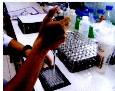
ภาพที่ ข9. การดูดตัวอย่างสารละลายลงใน Microplate
