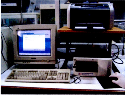
ภาพที่ ข11. การวัดค่า Absorbance ของสารหลังเกิดปฏิกิริยาด้วย Microplate reader
