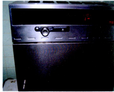
ภาพที่ ข8. การย่อยตัวอย่างปัสสาวะในตู้อบลมร้อนที่อุณหภูมิ 100 องศาเซลเซียส
