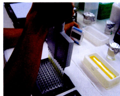
ภาพที่ ข10. การเติมสารละลาย Arsenious oxide และ Ceric sulfate ใน Microplate
