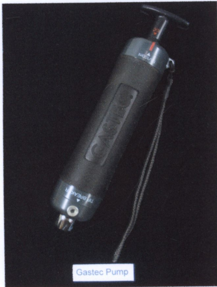
ภาพผนวก เครื่องมือวัดความเข้มข้นของไอโซน (gastech pump) (ก) และ detector tube No. 18 (ข) ที่ใช้วัดความเข้มข้นของก๊าซไอโซนในช่วง 20-200 ppm
