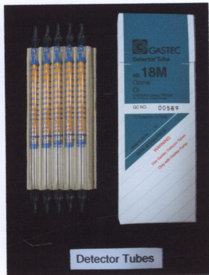
ภาพผนวก เครื่องมือวัดความเข้มข้นของไอโซน (gastech pump) (ก) และ detector tube No. 18 (ข) ที่ใช้วัดความเข้มข้นของก๊าซไอโซนในช่วง 20-200 ppm
