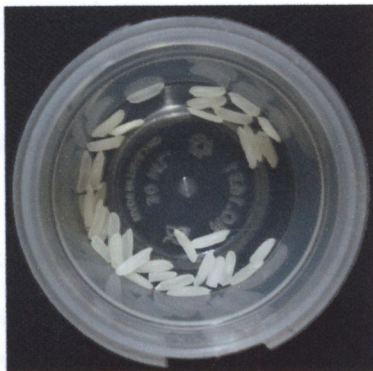
ภาพ 3.12 ถ้วยพลาสติกขนาดเส้นผ่านศูนย์กลาง 5 เซนติเมตร สูง 2.5 เซนติเมตร ที่ใช้บรรจุ
