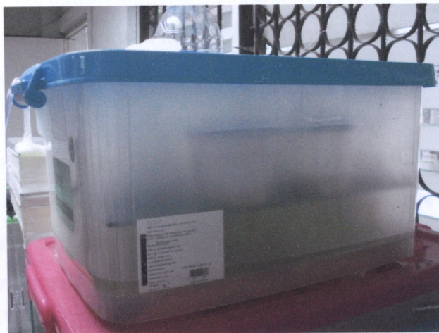
ภาพ 3.11 กล่องปรับความชื้นสัมพัทธ์ 75% ด้วยสารละลายอิมมิดัวของเกลือโซเดียมคลอไรด์ ที่ใช้ในการเลี้ยงด้วงงวงข้าว
