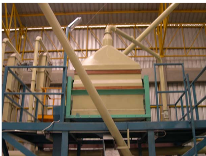
ภาพที่ 43 กระบวนการทำความสะอาดและคัดแยกสิ่งสกปรก
