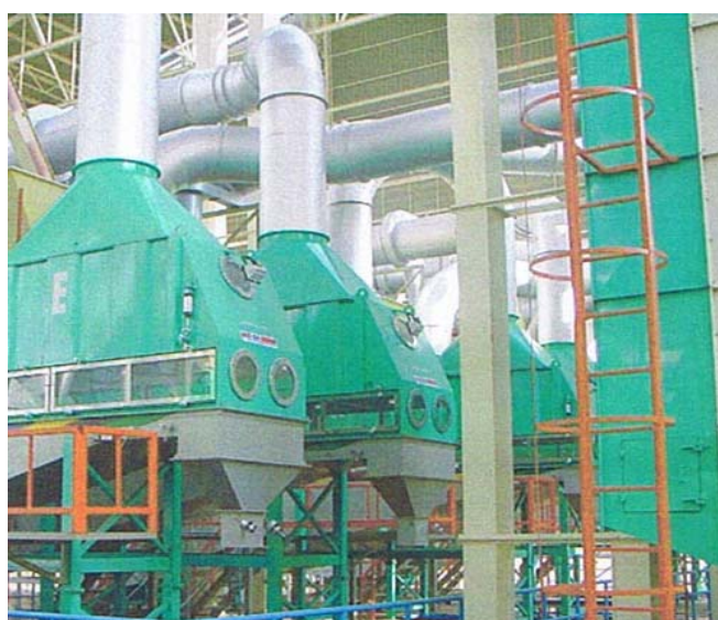
ภาพที่ 41 กระบวนการอบลดความชื้นข้าว
