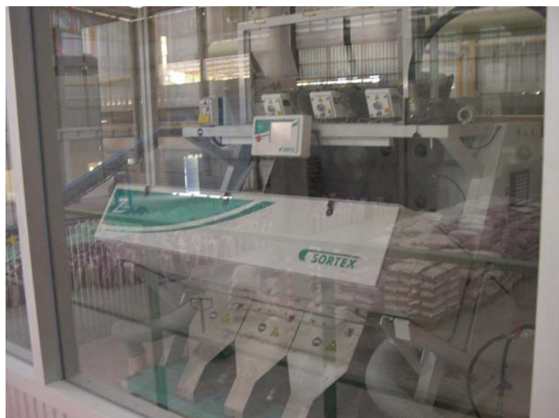
ภาพที่ 51 เครื่องคัดแยกสีที่ใช้ในโรงปรับปรุงคุณภาพตัวอย่าง
