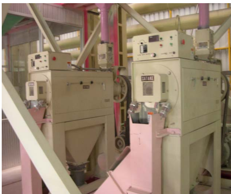
ภาพที่ 45 กระบวนการขัดมัน
