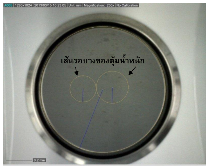
ภาพที่ 13 แสดงภาพเส้นรอบวงของตุ่มน้ำหนักรทั้งสองที่วางบนจานชั่งน้ำหนักหลังจากนำตุ่มน้ำหนักรออก
