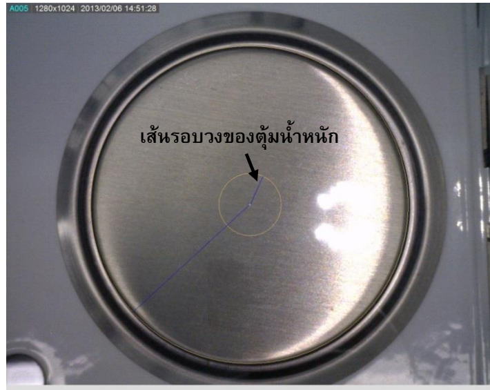
ภาพที่ 10 แสดงภาพเส้นรอบวงของตุ้มน้ำหนักที่ถูกนำมาวางบนจานชั่งน้ำหนักก่อนหน้านี
