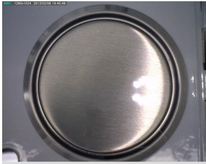
ภาพที่ 6 ภาพจานชั่งน้ำหนักของเครื่องชั่งเมื่อส่องด้วยกล้องจุลทรรศน์ดิจิทัล
