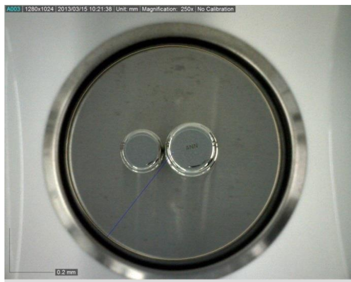
ภาพที่ 11 แสดงภาพของการวางตุ้มน้ำหนัก 2 ตุ้มบนจานชั่งน้ำหนัก
