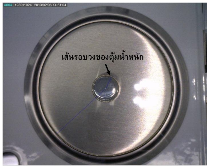
ภาพที่ 9 การใช้คำสั่ง Three Points Circle วาดเส้นรอบวงของตุ้มน้ำหนักที่อยู่บนจานชั่งน้ำหนัก
