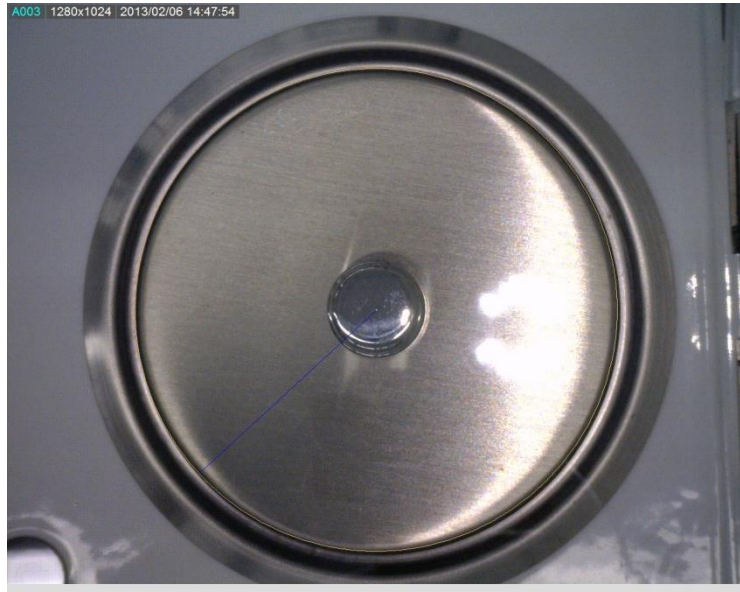
ภาพที่ 8 แสดงภาพตุ้มน้ำหนักที่อยู่บนจานชั่งน้ำหนักเมื่อทำการวางให้ตำแหน่งจุดศูนย์กลางของตุ้มน้ำหนักอยู่ใกล้เคียงกับตำแหน่งจุดศูนย์กลางของจานชั่งน้ำหนัก
