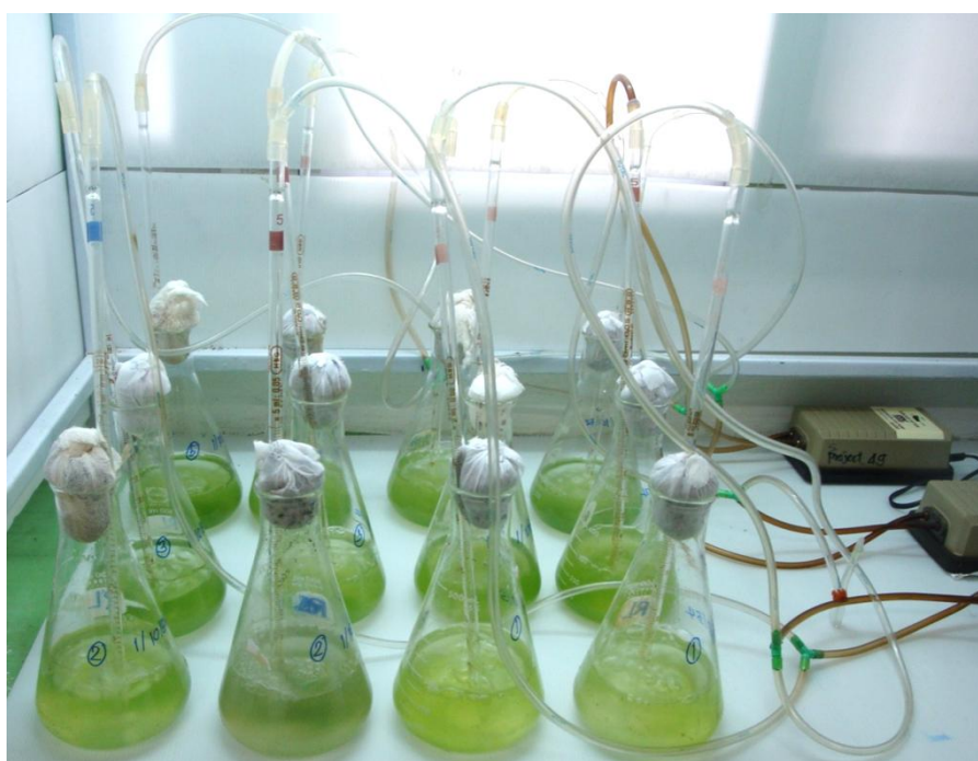
รูปที่ 3.3 การเพาะเลี้ยงสาหร่ายที่คัดเลือกได้ด้วยการเพาะเลี้ยงแบบสังเคราะห์แสง (photoautotrophic cultivation) ในอาหารเลี้ยงเชื้อ Bristol medium ให้อากาศผ่านเครื่องให้อากาศขนาดเล็ก ที่อุณหภูมิห้อง ภายใต้แสงจากหลอดฟลูออเรสเซนต์
