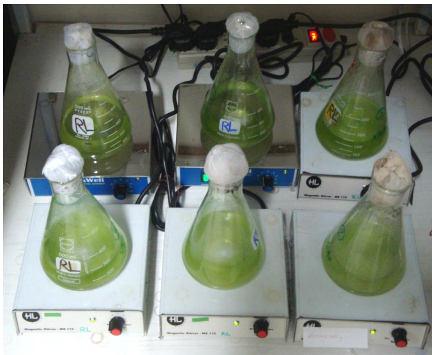
รูปที่ 3.4 การเพาะเลี้ยงสาหร่ายที่คัดเลือกได้ด้วยการเพาะเลี้ยงแบบไม่มีแสง (heterotrophic cultivation) ในอาหารเลี้ยงเชื้อ Bristol medium ที่มีกลูโคส 20g/L เป็นแหล่งคาร์บอน บ่มแบบกวนผสม ด้วยแท่งแม่เหล็กด้วยเครื่อง magnetic stirrer plate ที่อุณหภูมิห้อง
