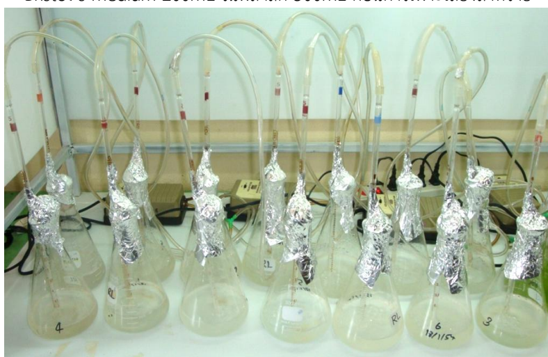
รูปที่ 3.2 การเพาะเลี้ยงเพิ่มจำนวนสาหร่ายในอาหาร Bristol's medium ที่อุณหภูมิห้อง ภายใต้แสงจากหลอดฟลูออเรสเซนต์ โดยพ่นให้อากาศด้วยเครื่องพ่นอากาศขนาดเล็ก บ่มเป็นเวลา 14 วัน
