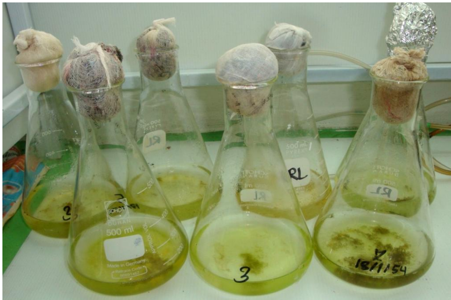
รูปที่ ก-5 การเจริญเพิ่มจำนวนสาหร่ายในอาหาร Bristol's medium ที่อุณหภูมิห้อง ภายใต้แสงจากหลอดฟลูออเรสเซนต์ โดยฟั่นให้อากาศด้วยเครื่องฟั่นอากาศขนาดเล็ก ภายหลังการบ่มเป็นเวลา 14 วัน
